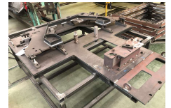
ブルSUB DKT溶接治具
